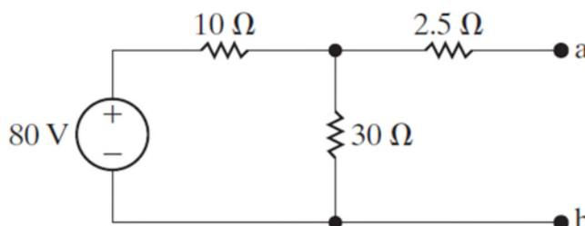
14 如圖所示之並聯電路，依節點電壓法，求  $V_x$  為多少伏特 (V)？
