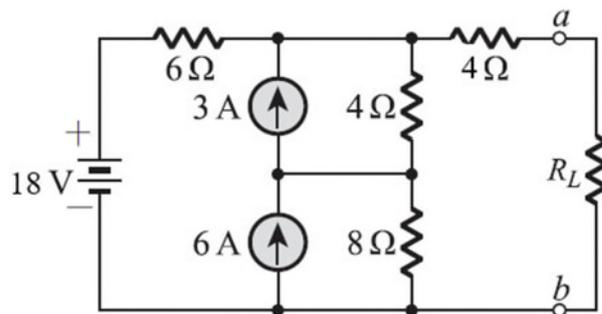
13 如圖所示的電路，a、b 兩端的戴維寧等效電壓  $E_{TH}$  及等效電阻  $R_{TH}$  分別為何？
